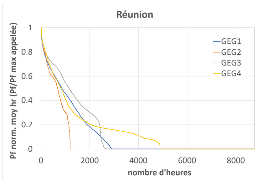
Figure 3 : Courbe monotone normalisée par rapport à la puissance maximale appelée sur l'année pour les 4 sites
