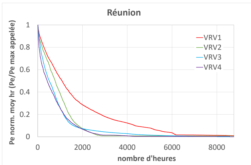
Figure 13 : Courbe monotone normalisée par rapport à la puissance maximale appelée sur l'année pour les 4 sites
